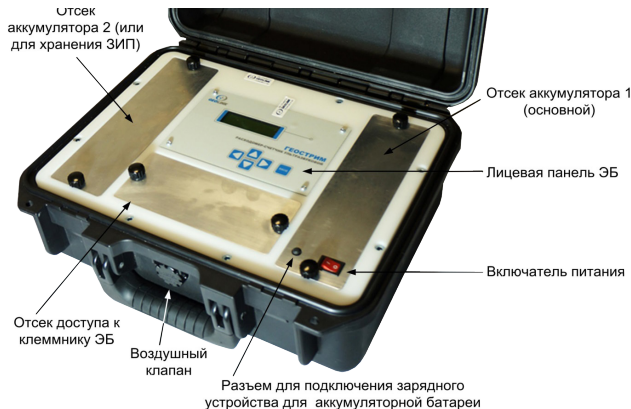
Рисунок Б.12 – Вид элементов расходомера при размещении в кейсе
