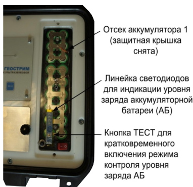
Рисунок Б.13 – Вид отсека основного аккумулятора
